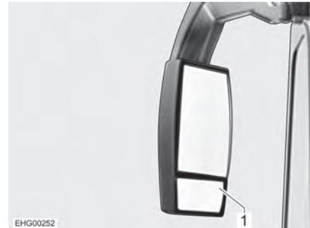
Fig. 29 Rétroviseur extérieur (modèle I)
