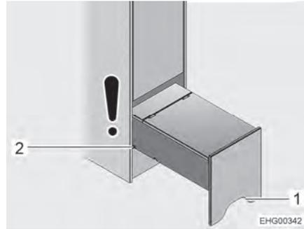
Fig. 83 Aide à la montée (entièrement sortie)
