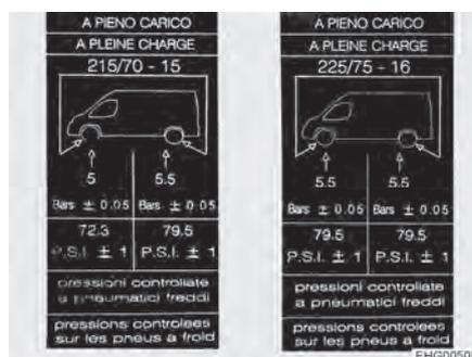
Fig. 173 Autocollant d'indication de la pression des pneus sur le montant B (exemple)
