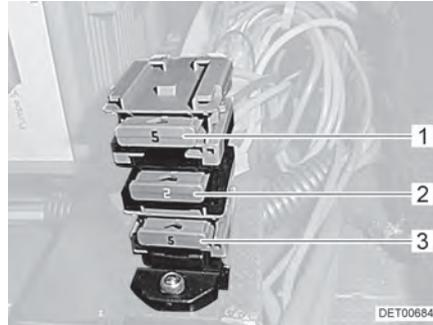
Fig. 110 Fusibles à côté du bloc électrique (Fiat/Citroën)
