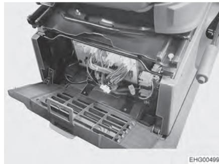
Fig. 98 Emplacement bloc électrique (Fiat/Citroën)
