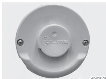
Fig. 125 Cheminée murale (chauffage à air chaud)
