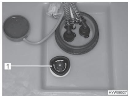
Fig. 139 Réservoir d'eau avec poignée tournante
