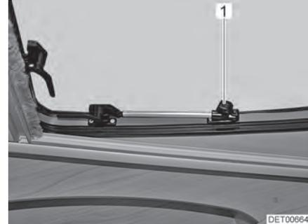
Fig. 47 Toit ouvrant avec bras pivotants, ouvert
