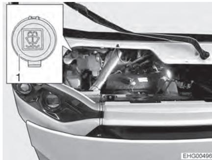
Fig. 11 Bec de remplissage (liquide d'essuie-glace)
