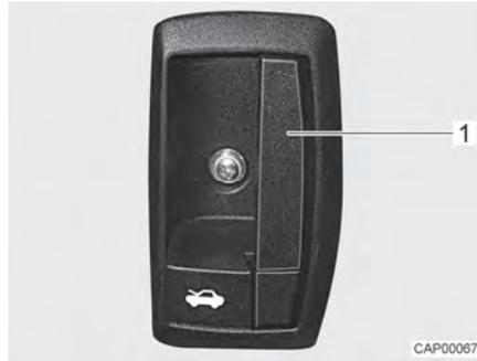
Fig. 9 Levier de déverrouillage (capot moteur)
