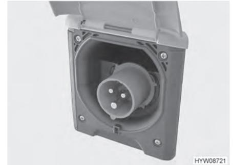
Fig. 103 Raccordement 230 V sur le véhicule (prise de courant CEE)
