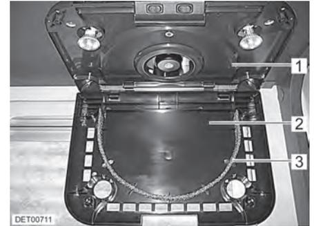
Fig. 160 Retirer le filtre à graisse
