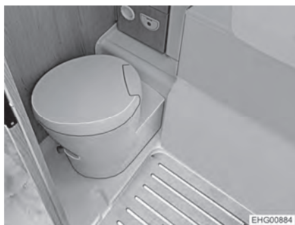
Bilde 152 Toalettsetet dreier mot veggen
