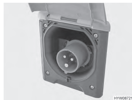
Bilde 103 230 V-tilkobling til kjøretøyet (CEE-stikkontakt)
