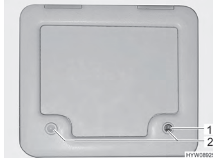
Bilde 157 Klaff for kloakktanken
