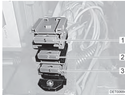
Bilde 110 Sikringer ved siden av strømsentralen (Fiat/Citroën)
