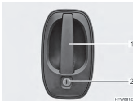
Bilde 31 Dørlås (førerdør/inngangsdør, utvendig)
