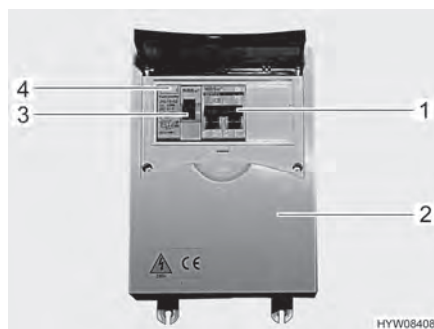
Bilde 102 230 V-sikringsboks med ledningsbeskyttelsesbryter og FI-bryter
