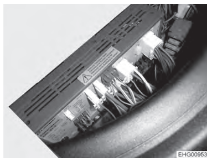
Bilde 99 Moneringssted for strømsentralen (Ford)
