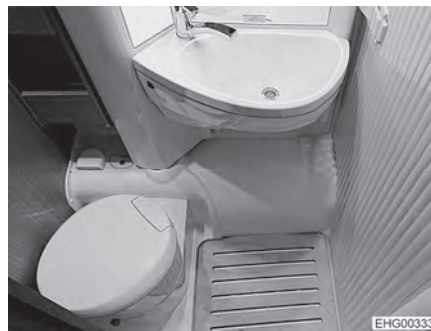
Bilde 148 Toalettsetet dreier mot veggen
