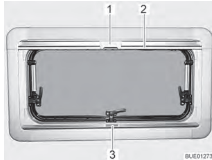
Bilde 43 Vindu med åpning utover
