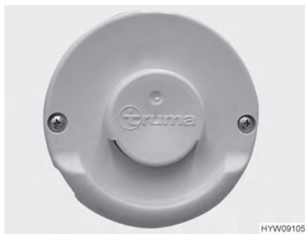
Bilde 113 Veggpipe (varmlufts-varmeanlegg)
