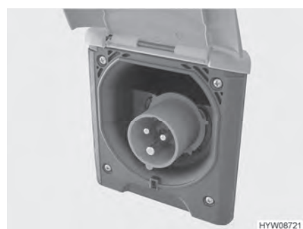
Bilde 99 230 V-tilkobling til kjøretøyet (CEE-stikkontakt)
