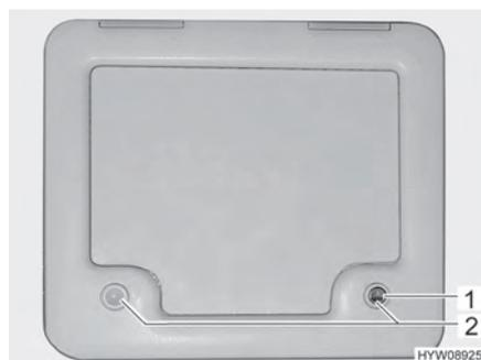
Fig. 144 Sportello per il serbatoio fecale
