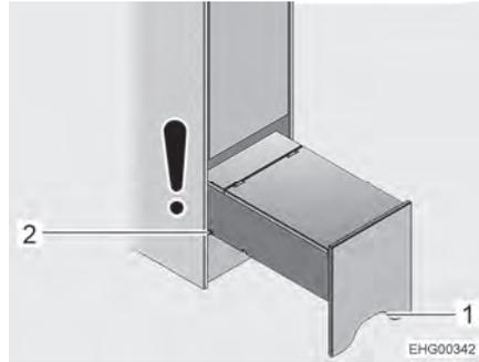
Fig. 81 Base di appoggio per la salita (completamente estratta)
