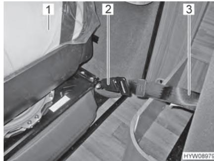
Fig. 19 Fissare il sedile installabile mediante la chiusura della cintura
