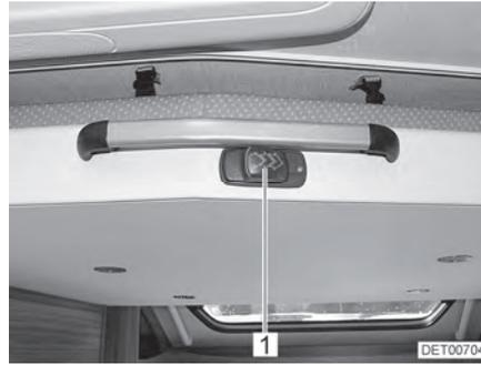
Fig. 73 Letto basculante con bloccaggio
