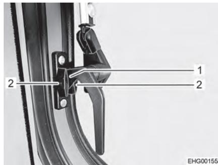
Fig. 42 Leva di serraggio, laterale (posizione "Aerazione continua")
