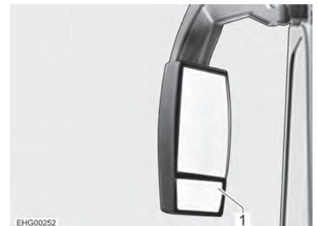
Fig. 28 Specchietto esterno (modello I)
