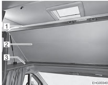
Fig. 71 Letto mansarda in posizione di marcia
