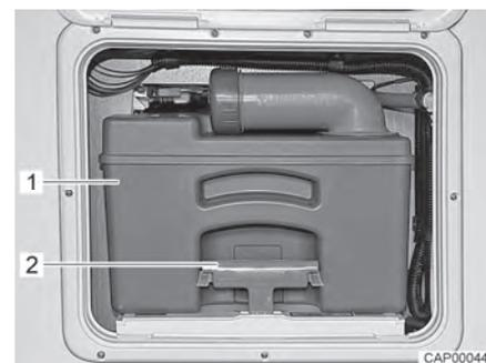
Fig. 145 Serbatoio fecale
