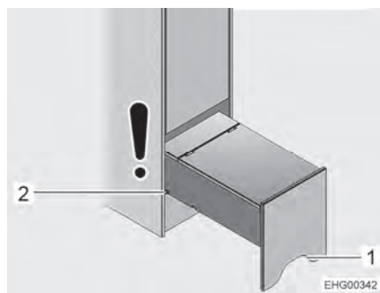
Kuva 81 Nousuapu (kokonaan ulos vedetty)
