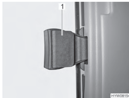
Kuva 36 Liukuikkuna ilman lukitusta
