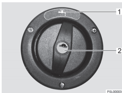
Afb. 126 Afsluitdeksel voor drinkwater-vulopening
