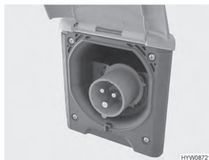
Afb. 99 230-V-aansluiting op het voertuig (CEE-contactdoos)
