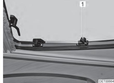
Fig. 46 Tragaluz con soportes giratorios, abierta
