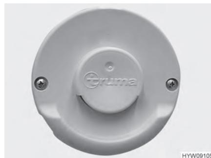
Fig. 113 Tubo de chimenea en la pared (calefacción de aire caliente)
