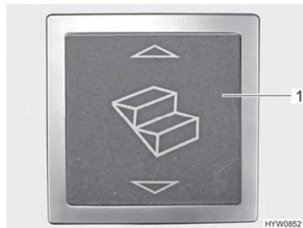
Fig. 1 Conmutador de mando del escalón de entrada
