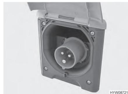
Fig. 99 Conexión de 230 V en el vehículo (caja de enchufe CEE)
