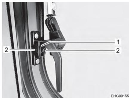
Fig. 42 Palanca de bloqueo de al lado (posición "Ventilación continua")
