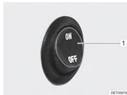
Fig. 135 Interruptor de luz del cuarto de aseo
