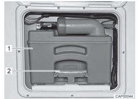
Fig. 145 Depósito de aguas fecales
