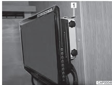
Bild 67 Flachbildschirm in Fahrtposition
