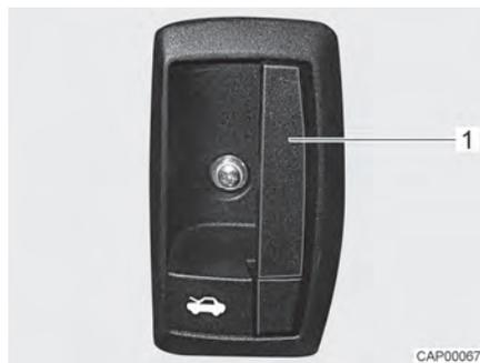
Bild 6 Entriegelungshebel (Motorhaube)
