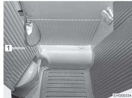
Bild 139 Große Schwenkwand, geschwenkt
