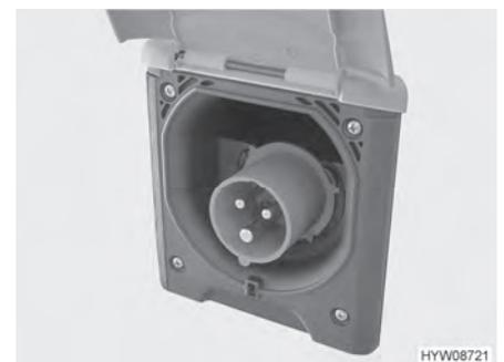
Bild 99 230-V-Anschluss am Fahrzeug (CEE-Steckdose)
