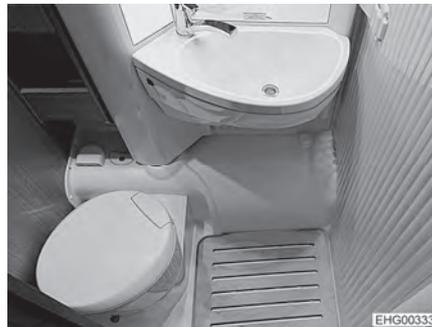
Bild 138 Toilettensitz, zur Wand gedreht
