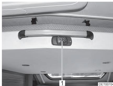
Fig. 73 Lit escamotable avec verrouillage
