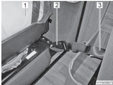
Fig. 19 Bloquer le siège emboîtable avec la boucle de fermeture de la ceinture
