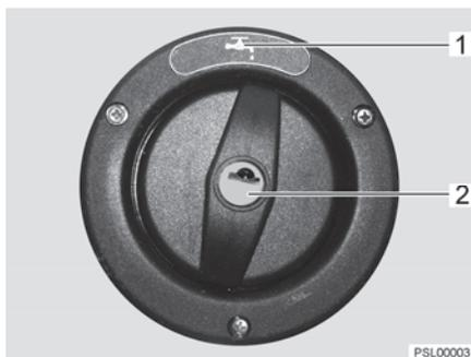
Fig. 126 Couvercle de fermeture pour bec de remplissage d'eau potable
