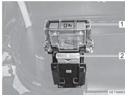
Fig. 102 Fusibles de la batterie de cellule
