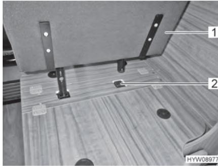
Fig. 17 Ficher le siège emboîtable dans sa fixation
