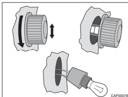
Fig. 151 Indicateur de direction latéral (12 V/5 W)
