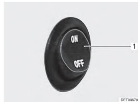
Fig. 135 Commutateur d'éclairage cabinet de toilette
