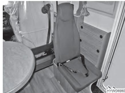
Fig. 20 Siège emboîtable (ouvert)
