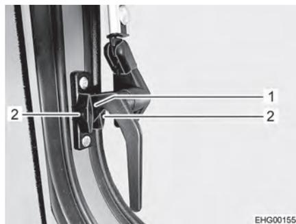
Fig. 42 Levier de verrouillage, latéral, (position "Aération permanente")
