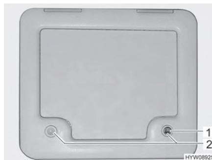
Fig. 144 Portillon pour le réservoir pour matières fécales
