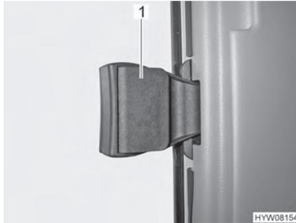
Fig. 36 Fenêtre coulissante sans verrouillage
