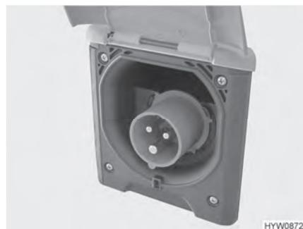
Fig. 99 Raccordement 230 V sur le véhicule (prise de courant CEE)
