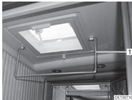
Bild 141 Kleiderstange zum Trocknen von Wäsche
