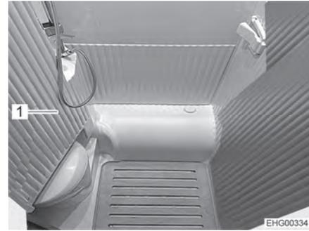
Bild 144 Große Schwenkwand, geschwenkt
