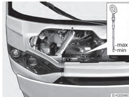
Bild 9 Ölmesstab (Motoröl)
