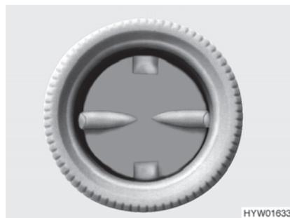
Bild 112 Luftaustrittsdüse (Warmluft-Heizung)
