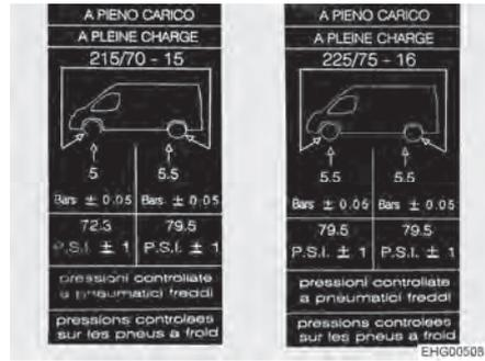
Bild 164 Hinweisaufkleber zum Reifendruck an B-Säule (Beispiel)
