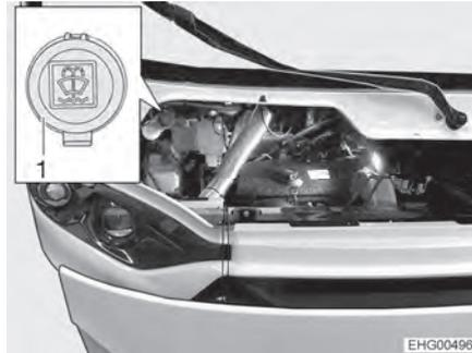
Bild 8 Einfüllstutzen (Scheibenwaschwasser)
