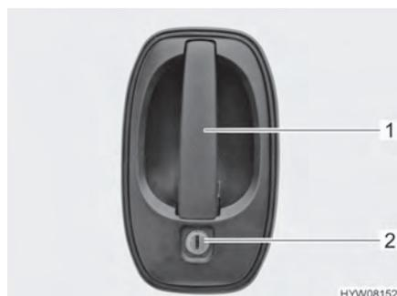
Fig. 28 Serrure de la porte (porte chauffeur/cellule à l'extérieur)
