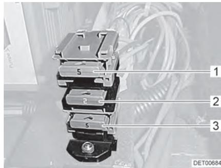
Fig. 104 Fusibles à côté du bloc électrique
