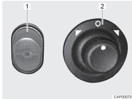
Fig. 25 Interrupteurs (rétroviseurs extérieurs à réglage électrique)
