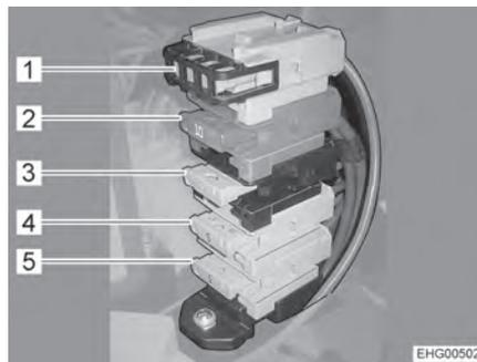
Fig. 105 Fusibles à côté du bloc électrique avec dispositif de montage du groupe solaire et antenne parabolique
