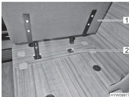
Fig. 16 Ficher le siège emboîtable dans sa fixation
