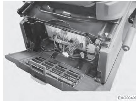
Fig. 94 Emplacement bloc électrique
