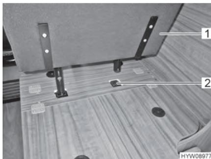
Fig. 16 Inserire il sedile installabile nel supporto
