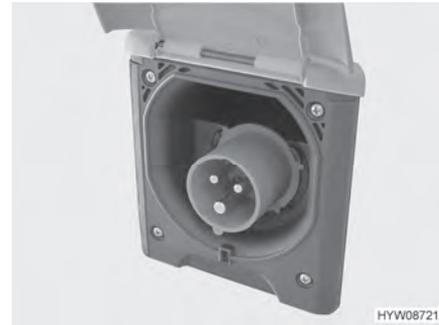
Fig. 98 Collegamento a 230 V al veicolo (presa CEE)
