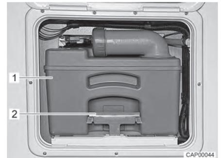
Fig. 150 Serbatoio fecale
