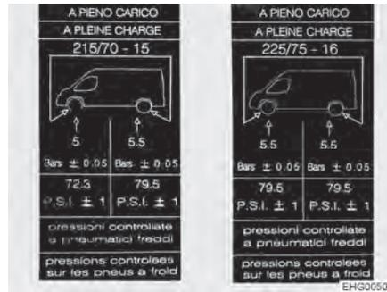
Fig. 164 Etichetta di avvertenza pressione degli pneumatici applicato su montante B (esempio)
