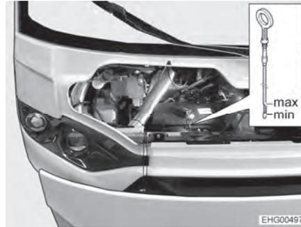
Fig. 9 Astina di livello olio (olio motore)
