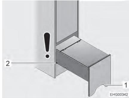
Fig. 79 Base di appoggio per la salita (completamente estratta)
