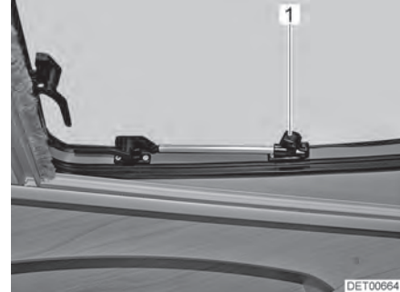
Afb. 44 Dakraam met draaibare uitzetters, geopend
