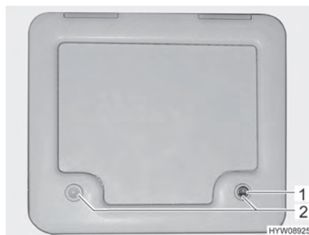
Fig. 149 Trampilla para el depósito de aguas fecales
