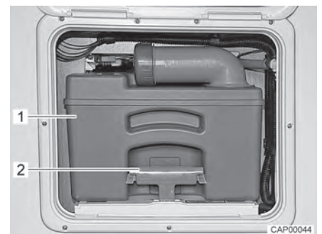
Fig. 150 Depósito de aguas fecales
