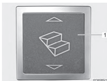
Fig. 1 Conmutador de mando del escalón de entrada
