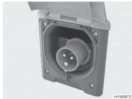
Bild 52 230 V-anslutning på fordonet (CEE-uttag)
