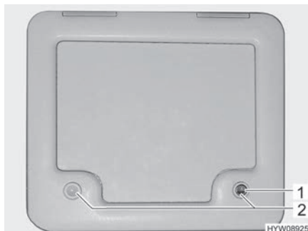
Bild 83 Lucka för latrintanken
