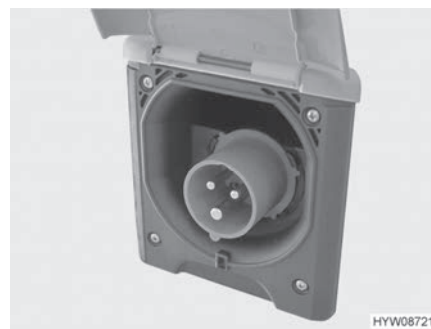
Bilde 52 230 V-tilkobling til kjøretøyet (CEE-stikkontakt)
