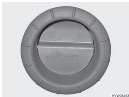
Bilde 58 Luftdyse (varmlufts-varmeanlegget)
