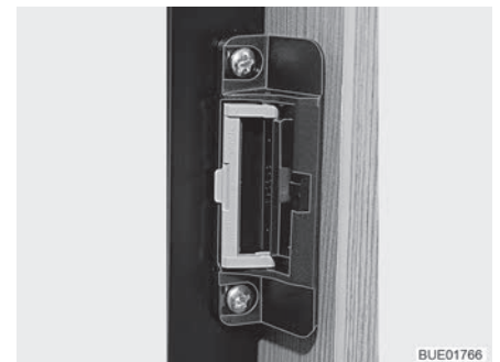
Fig. 69 Dispositivo di chiusura in posizione di ricircolo d'aria
