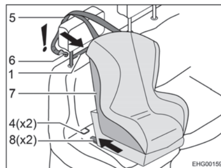
Fig. 8 Fissaggio con Isofix
