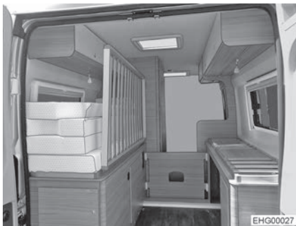
Fig. 35 Posizione di trasporto (rete del letto ribaltabile)
