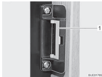
Fig. 68 Dispositivo di chiusura in posizione normale
