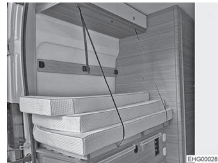
Fig. 36 Posizione di trasporto (rete del letto estraibile)
