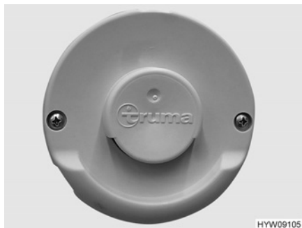
Bilde 88 Veggpipe (varmlufts-varmeanlegg)
