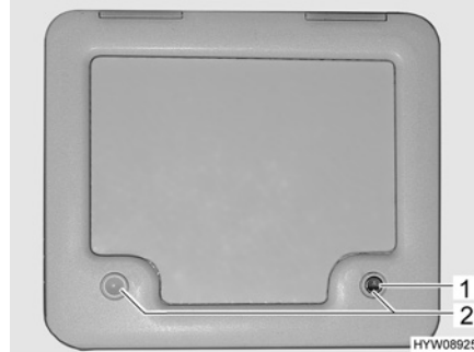
Bilde 117 Klaff for kloakktanken
