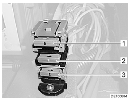
Bilde 78 Sikringer ved siden av strømsentralen
