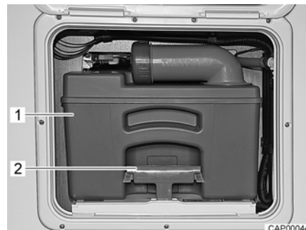
Fig. 118 Réservoir pour matières fécales
