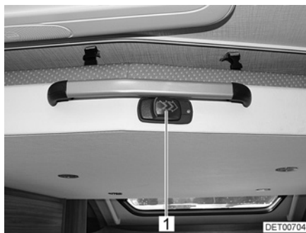
Fig. 52 Lit escamotable avec verrouillage
