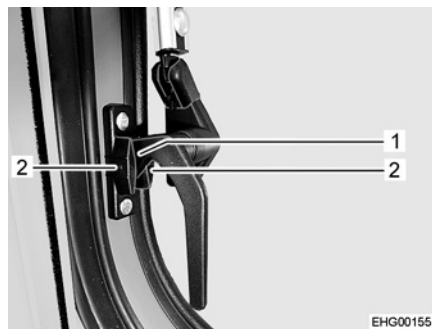
Fig. 27 Levier de verrouillage, latéral, (position "Aération permanente")
