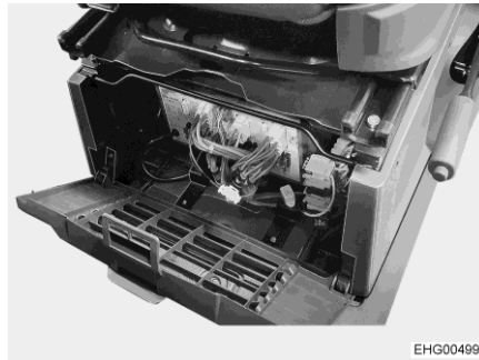
Fig. 82 Lugar de instalación del bloque eléctrico (Stellantis)
