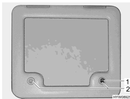
Fig. 131 Trampilla para el depósito de aguas fecales
