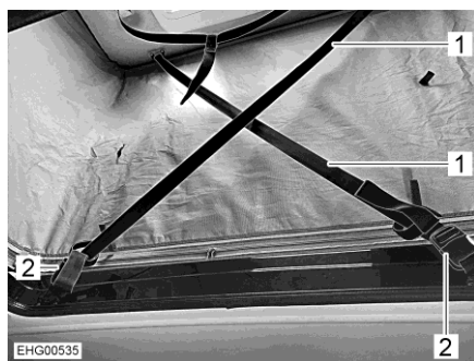
Fig. 75 Protección contra el viento
