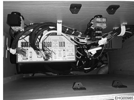
Fig. 83 Lugar de instalación del bloque eléctrico (Ford)
