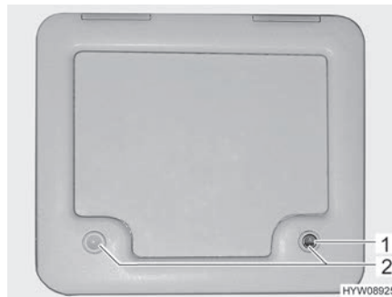
Bild 155 Klappe für den Fäkalientank
