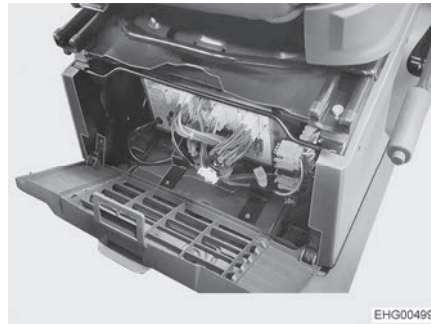
Bild 102 Einbauort Elektroblock (Stellantis), Abb. ähnlich
