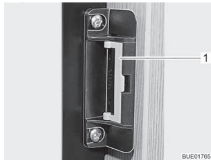
Bild 133 Verschlusseinrichtung in Normalstellung
