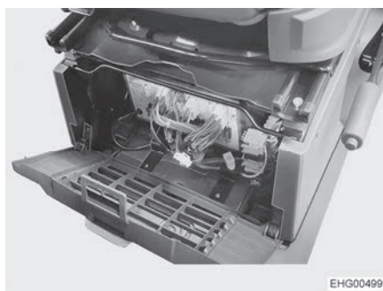
Fig. 102 Ubicazione centralina elettrica (Stellantis), fig. simile
