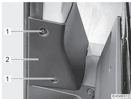
Fig. 116 Copertura (vista dalla porta della cabina di guida)
