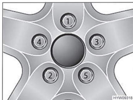
Fig. 167 Serraggio a croce di dadi delle ruote e bulloni delle ruote
