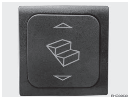
Fig. 7 Interruttore a bilico scalino di ingresso
