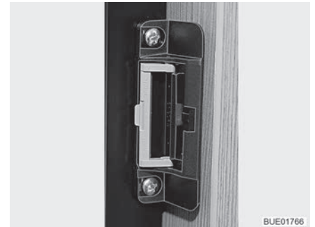
Fig. 134 Dispositivo di chiusura in posizione di ricircolo d'aria
