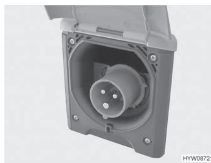
Fig. 107 Collegamento a 230 V al veicolo (presa CEE)
