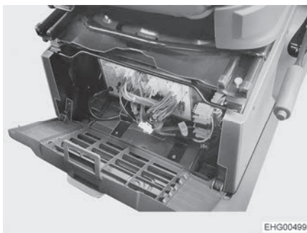
Fig. 102 Emplacement bloc électrique (Stellantis), fig. similaire
