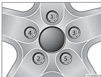
Fig. 167 Serrer en croix les écrous ou les boulons de roue
