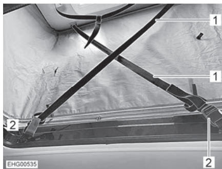
Fig. 94 Protección contra el viento
