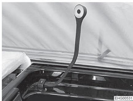
Fig. 95 Lámpara de cuello de cisne, posición de funcionamiento
