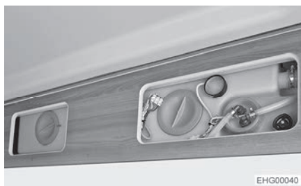
Fig. 137 Depósito de agua
