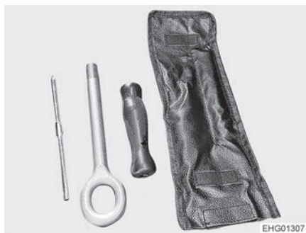
Fig. 165 Argolla de remolque y destornillador (vehículo con base de Stellantis)
