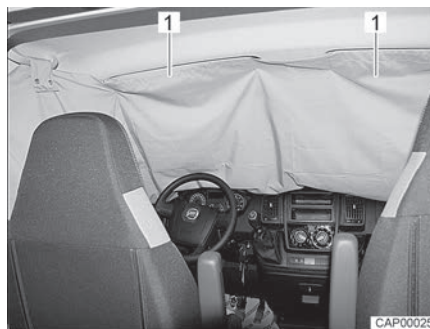
Fig. 36 Oscurecedor de la cabina del conductor en la luna delantera
