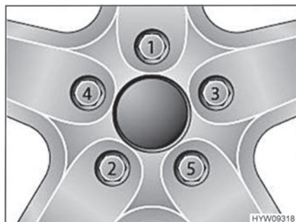
Fig. 167 Apretar las tuercas o los tornillos de las ruedas en forma de cruz
