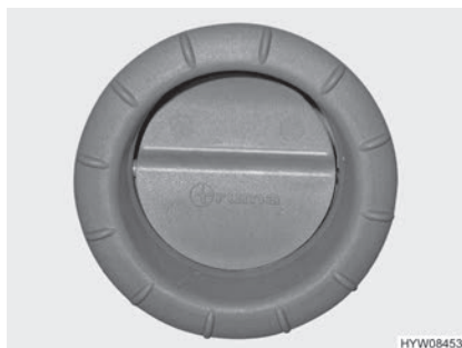
Fig. 120 Boquilla de salida de aire (calefacción de aire ca- liente)
