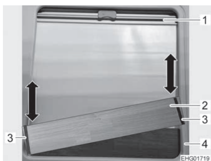
Fig. 74 Protección contra caídas de parte trasera
