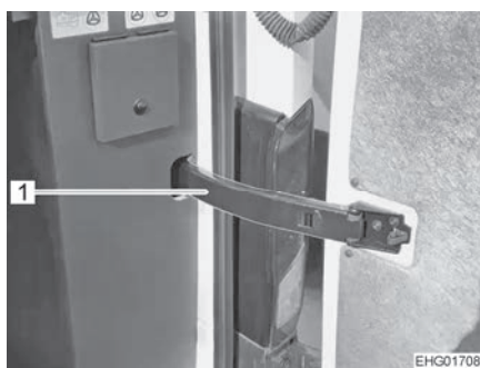
Fig. 27 Limitación del ángulo de apertura (vehículo básico VW)
