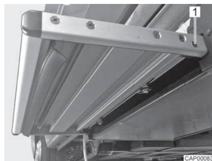
Fig. 158 Tope (escalón de entrada)
