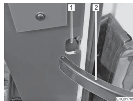
Fig. 28 Limitación del ángulo de apertura, desbloqueada (vehículo básico VW)
