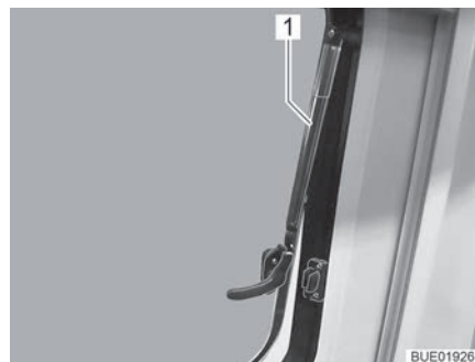
Fig. 30 Ventana abatible con soportes automáticos, abierta
