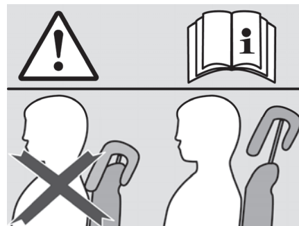
Fig. 19 Ajuste correcto de los reposacabezas
