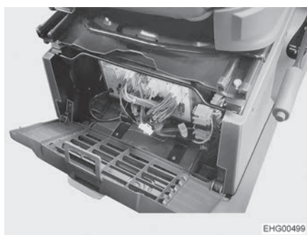
Fig. 102 Lugar de instalación del bloque eléctrico (Stellantis), fig. similar
