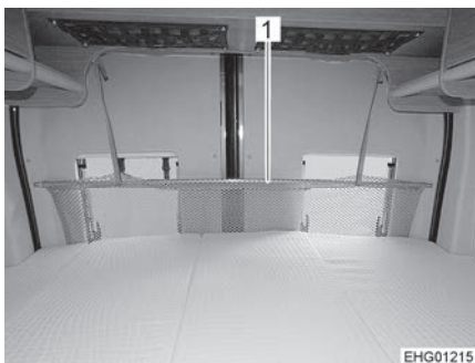
Bild 73 Fallskydd (längsgående bakre säng)
