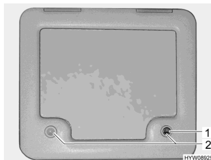
Bilde 113 Klaff for kloakktanken
