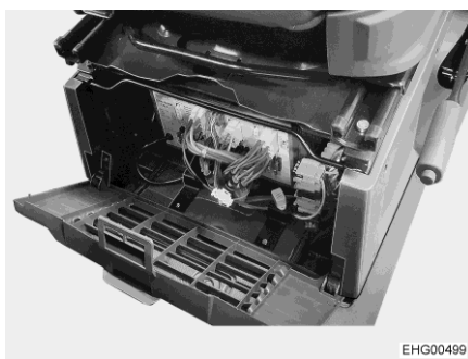
Bilde 71 Monteringssted for strømsentralen
