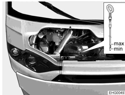
Fig. 9 Varilla del nivel de aceite (aceite del motor)
