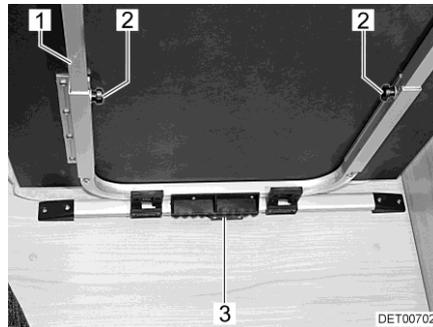
Fig. 55 Desplazamiento/ampliación de la mesa colgante
