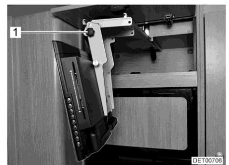
Fig. 64 Pantalla plana en posición de televisión
