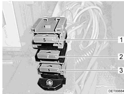
Fig. 104 Fusibles junto al bloque eléctrico
