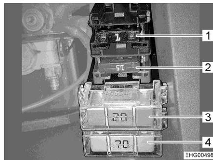
Fig. 101 Fusibles en la batería del motor de arranque con amplificador carga
