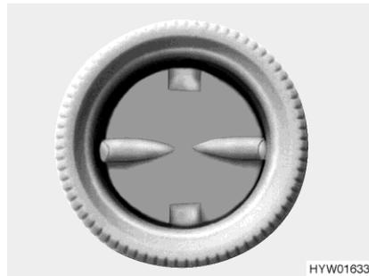
Fig. 112 Boquilla de salida de aire (calefacción de aire caliente)
