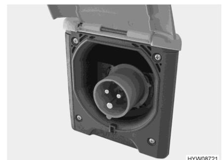
Fig. 98 Conexión de 230 V en el vehículo (caja de enchufe CEE)
