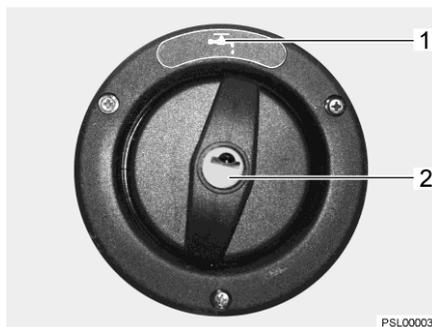
Fig. 131 Tapa de cierre para el tubo de llenado de agua potable
