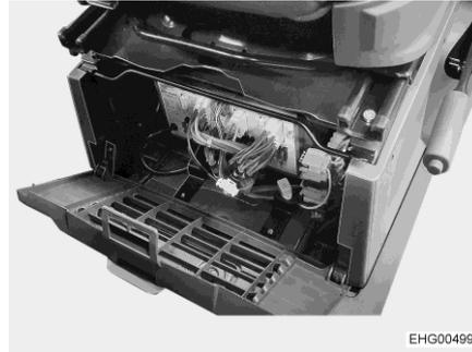
Fig. 94 Lugar de instalación del bloque eléctrico
