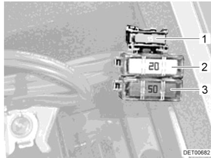
Fig. 100 Fusibles en la batería del motor de arranque sin amplificador de carga
