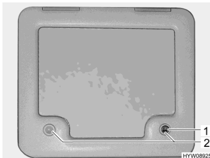
Bild 149 Lucka för latrintanken
