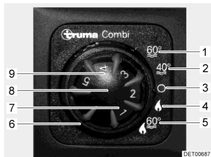
Fig. 113 Centralina di controllo
