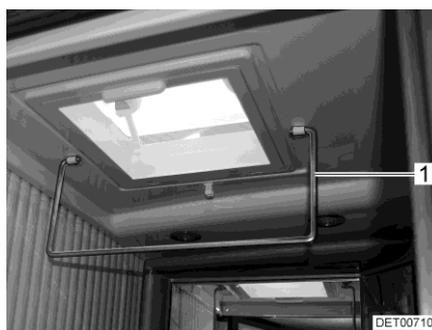
Fig. 141 Appendiabiti per asciugatura della biancheria
