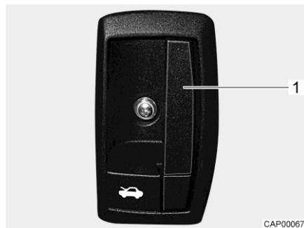
Fig. 6 Leva di sbloccaggio (cofano motore)
