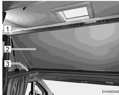
Fig. 69 Letto mansarda in posizione di marcia
