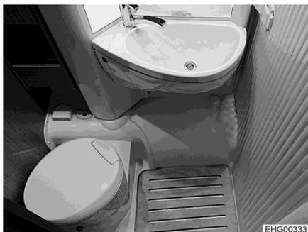
Fig. 143 Sedile del WC, ruotato verso la parete
