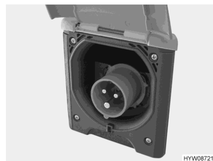
Bilde 98 230 V-tilkobling til kjøretøyet (CEE-stikkontakt)
