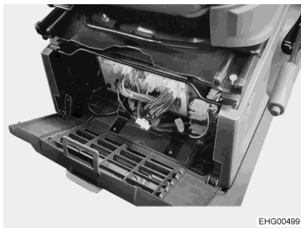
Bilde 94 Monteringssted for strømsentralen
