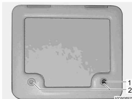
Bilde 149 Klaff for kloakktanken
