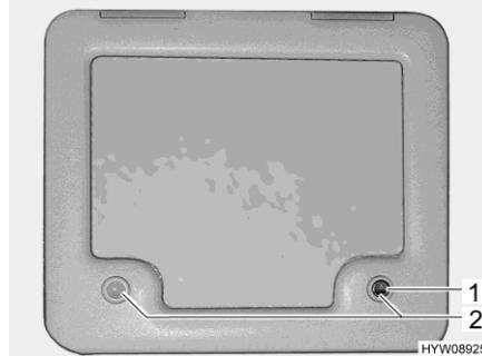
Fig. 113 Sportello per il serbatoio fecale
