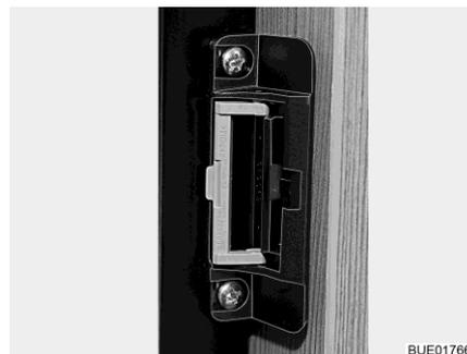
Fig. 98 Dispositivo di chiusura in posizione di ricircolo d'aria
