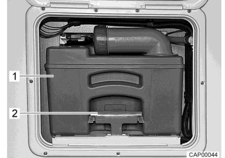
Fig. 114 Serbatoio fecale
