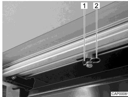
Fig. 115 Asta di azionamento (scalino di ingresso)
