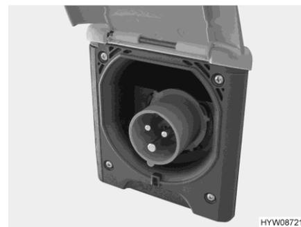
Fig. 75 Collegamento a 230 V al veicolo (presa CEE)
