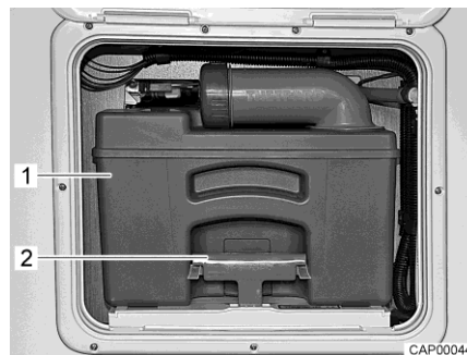
Fig. 114 Depósito de aguas fecales
