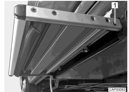
Fig. 116 Tope (escalón de entrada)
