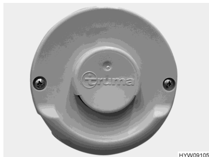
Fig. 92 Tubo de chimenea en la pared (calefacción de aire caliente)
