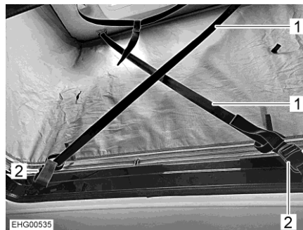
Fig. 59 Protección contra el viento
