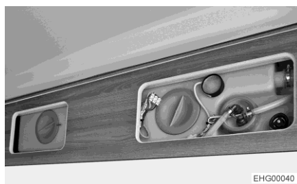
Fig. 99 Depósito de agua
