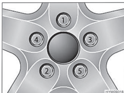
Kuva 112 Kiristä pyörien mutterit tai pultit ristiin
