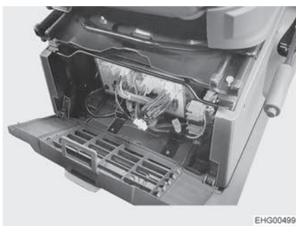
Kuva 63 Asennuspaikka, sähkö- ja elektroniikkayksikkö
