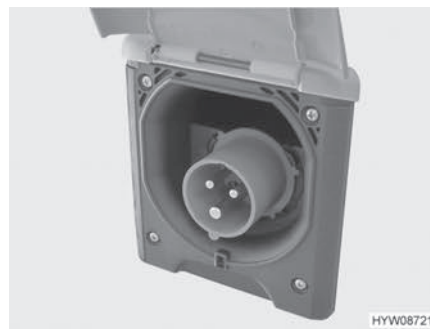
Kuva 67 230 V:n liitäntä ajoneuvolla (CEE-pistorasia)
