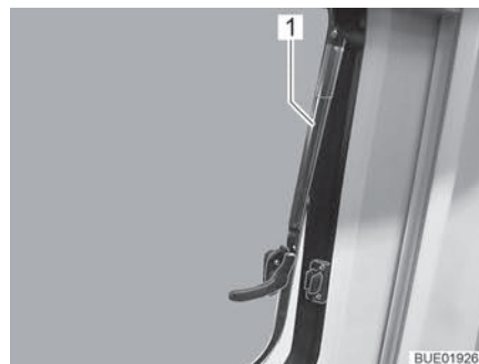
Kuva 13 Avattavat ikkunat, joissa on automaattipidikkeet, avattu
