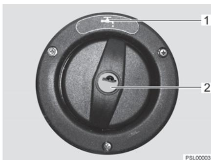
Fig. 90 Coperchio per bocchettone di riempimento dell'acqua potabile
