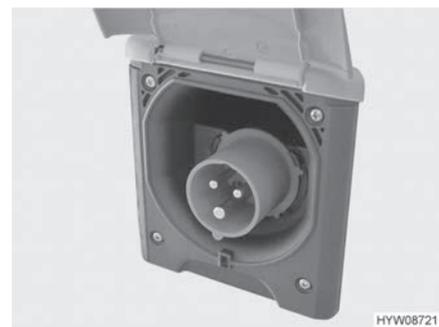
Fig. 67 Collegamento a 230 V al veicolo (presa CEE)
