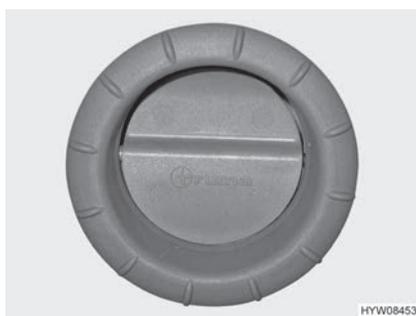
Fig. 77 Bocchetta di uscita dell'aria (riscaldamento ad aria calda)
