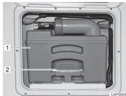
Fig. 104 Serbatoio fecale
