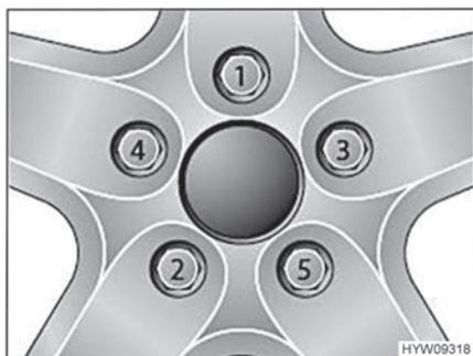
Fig. 112 Serraggio a croce di dadi delle ruote e bulloni delle ruote
