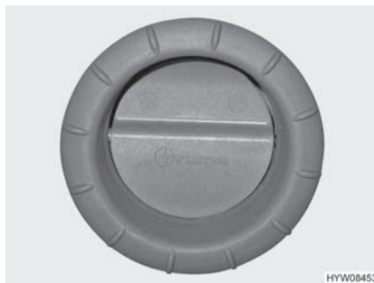
Bilde 77 Luftdyse (varmlufts-varmeanlegget)
