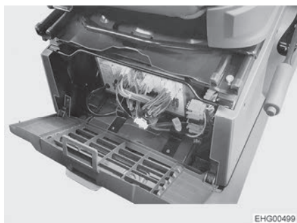
Bilde 63 Monteringssted for strømsentralen
