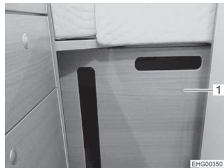
Bild 34 Mellanvägg med steg
