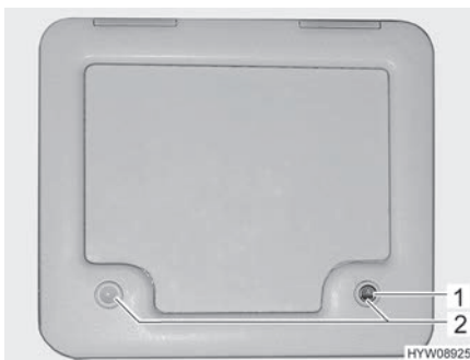
Bild 103 Lucka för latrintanken
