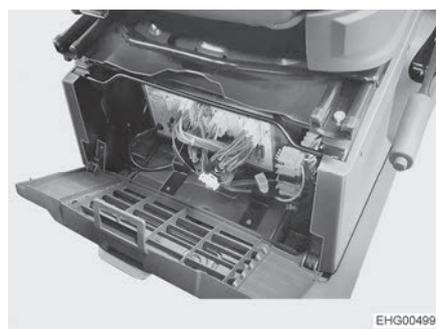
Fig. 63 Lugar de instalación del bloque eléctrico
