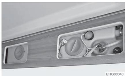
Fig. 89 Depósito de agua
