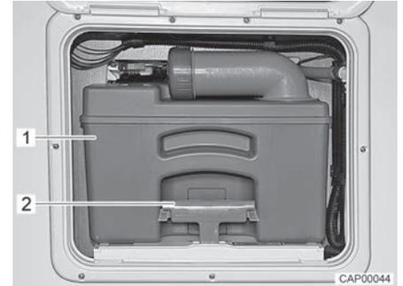
Fig. 104 Depósito de aguas fecales
