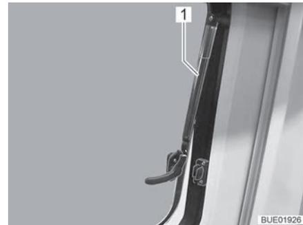
Fig. 13 Ventana abatible con soportes automáticos, abierta
