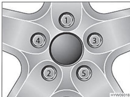
Fig. 112 Apretar las tuercas o los tornillos de las ruedas en forma de cruz
