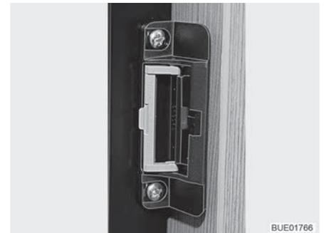
Fig. 88 Dispositivo de cierre en posición de ventilación
