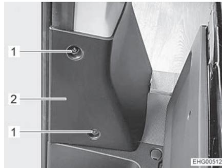
Fig. 73 Cache (vu de la porte de la cabine de conduite)
