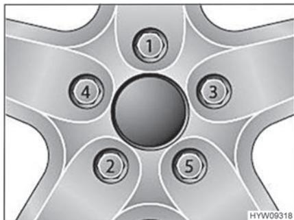
Fig. 112 Serrer en croix les écrous ou les boulons de roue
