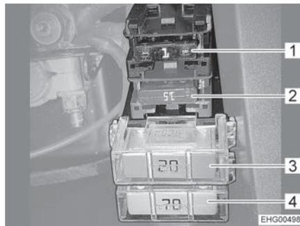
Fig. 70 Fusibles sur la batterie de démarrage avec booster de charge
