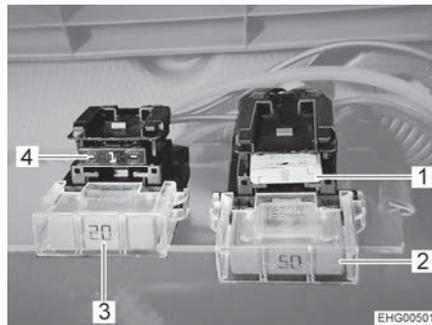
Fig. 71 Fusibles sur la batterie de cellule avec booster de charge
