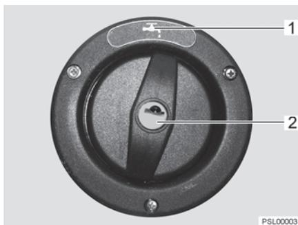
Fig. 90 Couvercle de fermeture pour bec de remplissage d'eau potable
