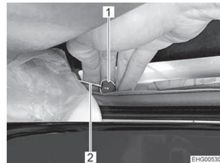
Fig. 48 Dispositif de déverrouillage de secours
