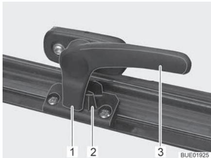
Fig. 12 Levier de verrouillage en position "Fermé"
