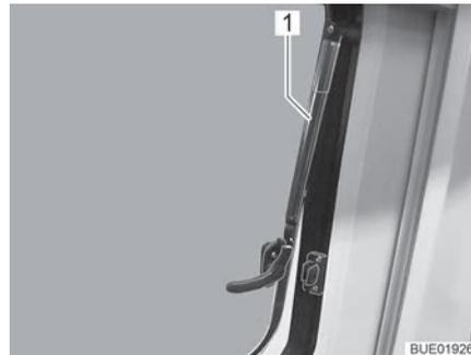
Fig. 13 Fenêtre projetante avec bras automatiques, ouverte
