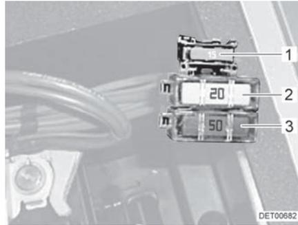
Fig. 69 Fusibles sur la batterie de démarrage sans booster de charge
