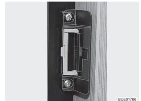
Fig. 88 Dispositif de fermeture en position de ventilation
