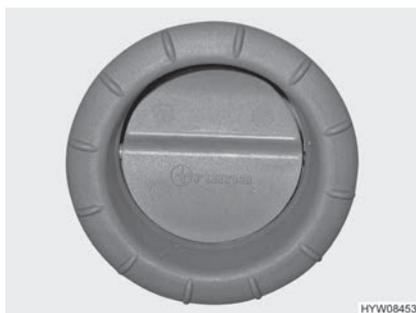
Fig. 77 Buse de sortie d'air (chauffage à air chaud)
