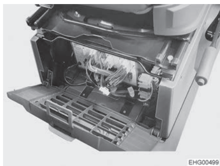
Afb. 151 Inbouwplaats elektroblok (Stellantis), afb. ter indicatie
