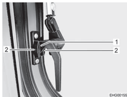
Afb. 64 Vergrendelingshendel, zijkant (stand "continue ventilatie")
