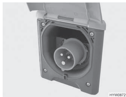
Afb. 156 230-V-aansluiting op het voertuig (CEE-contactdoos)
