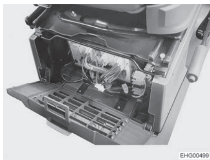
Fig. 151 Ubicazione centralina elettrica (Stellantis), fig. simile
