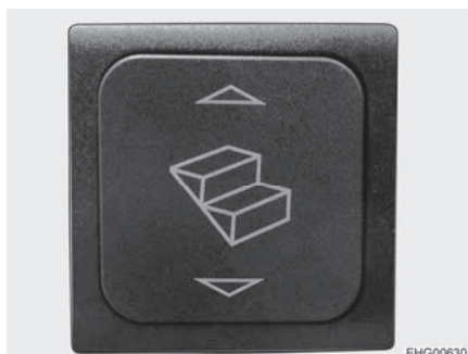
Fig. 10 Interruttore di comando scalino di ingresso
