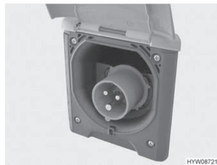
Fig. 156 Collegamento a 230 V al veicolo (presa CEE)
