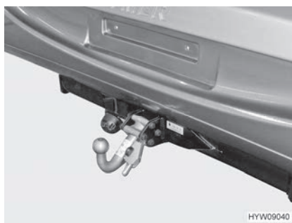
Fig. 9 gancio di traino, rimovibile (fig. esemplificativa)
