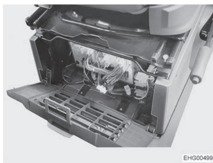
Fig. 151 Emplacement bloc électrique (Stellantis), fig. similaire
