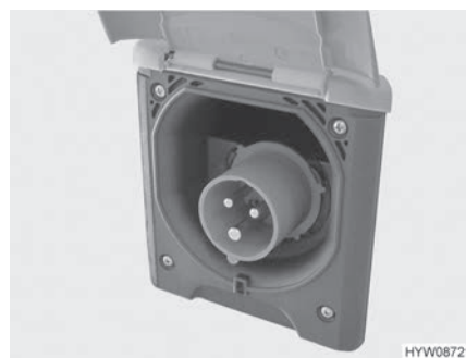
Fig. 156 Raccordement 230 V sur le véhicule (prise de courant CEE)
