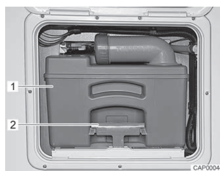
Fig. 211 Réservoir pour matières fécales
