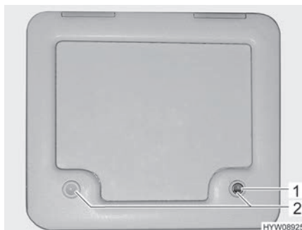
Bild 210 Lucka för latrintanken
