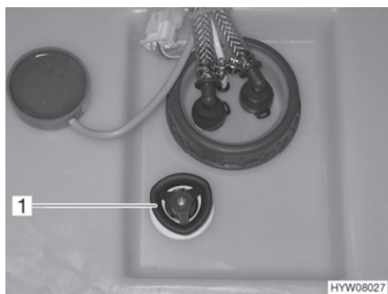
Bild 193 Vattentank med ratt
