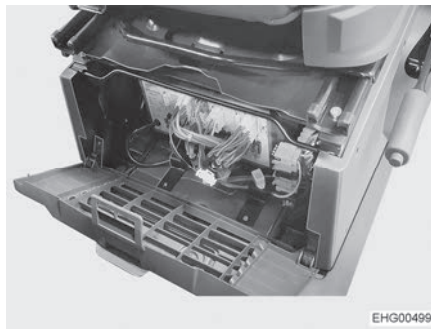
Bild 151 Monteringsställe för el-block (Stellantis), liknande avbildning
