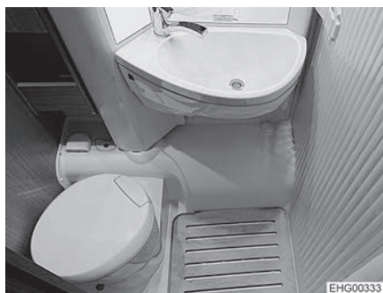
Bild 201 Toalettstol, vriden mot väggen
