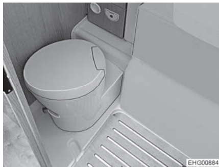
Kuva 205 WC-istuin, käännetty seinää päin
