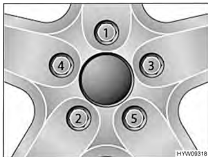
Bild 94 Dra fast hjulmuttrarna eller hjulbultarna korsvis
