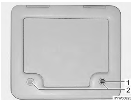
Bild 89 Lucka för latrintanken
