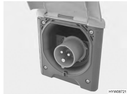
Fig. 57 Raccordement 230 V sur le véhicule (prise de courant CEE)
