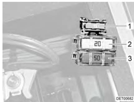
Fig. 59 Fusibles de la batterie de démarrage
