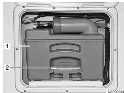
Fig. 90 Réservoir pour matières fécales
