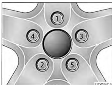
Fig. 94 Serrer en croix les écrous ou les boulons de roue
