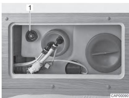
Fig. 79 Depósito de agua con tirador giratorio
