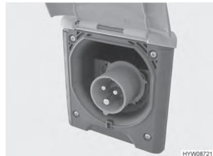
Fig. 57 Conexión de 230 V en el vehículo (caja de enchufe CEE)
