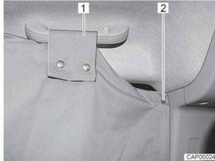
Fig. 17 Oscurecedor de la cabina del conductor en la luna lateral
