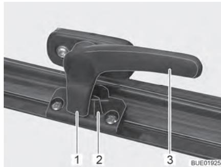
Fig. 12 Palanca de bloqueo en la posición "cerrada"
