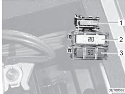
Fig. 59 Fusibles en la batería del motor de arranque
