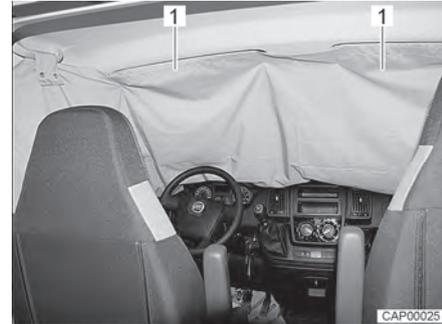
Fig. 18 Oscurecedor de la cabina del conductor en la luna delantera
