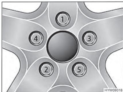
Fig. 94 Apretar las tuercas o los tornillos de las ruedas en forma de cruz
