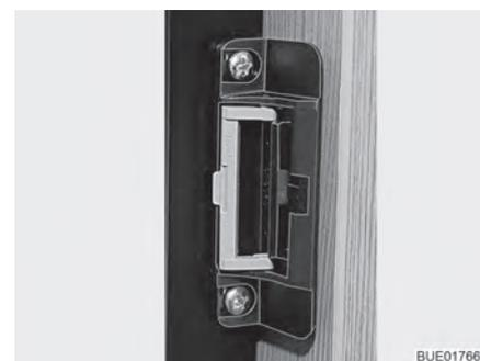
Fig. 74 Dispositivo de cierre en posición de ventilación
