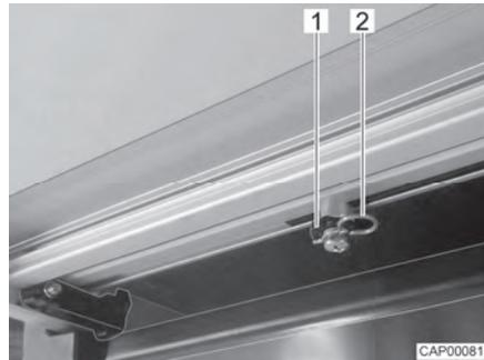
Fig. 91 Varilla de accionamiento (escalón de entrada)
