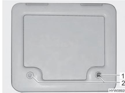
Bild 89 Klappe für den Fäkalientank
