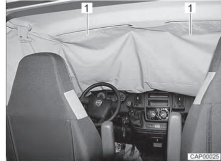
Bild 18 Fahrerhausverdunklung an Frontscheibe
