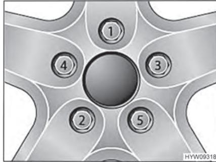
Bild 94 Radmuttern oder Radschrauben über Kreuz festziehen
