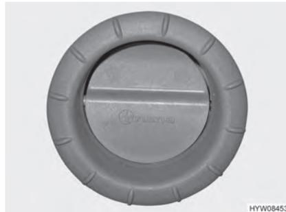
Bild 63 Luftaustrittsdüse (Warmluft-Heizung)
