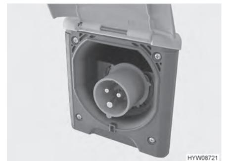
Bild 57 230-V-Anschluss am Fahrzeug (CEE-Steckdose)
