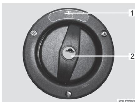
Bild 76 Verschlussdeckel für Trinkwasser-Einfüllstutzen
