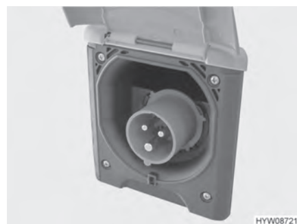
Afb. 57 230-V-aansluiting op het voertuig (CEE-contactdoos)
