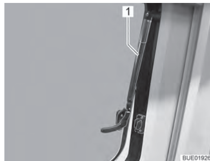
Afb. 13 Uitzetbaar raam met automatische uitzetters, geopend
