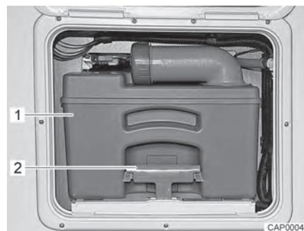
Fig. 90 Serbatoio fecale
