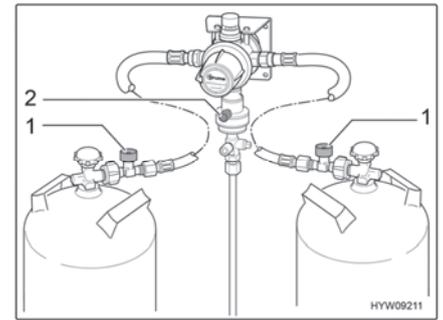
Fig. 6 Regolatore del gas (DuoControl)
