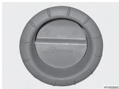
Fig. 63 Bocchetta di uscita dell'aria (riscaldamento ad aria calda)
