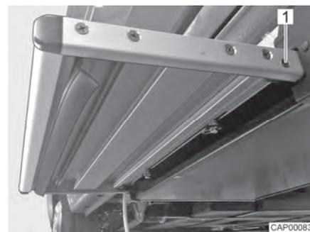
Fig. 92 Arresto (scalino di ingresso)
