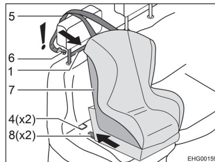
Fig. 9 Fissaggio con Isofix
