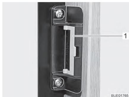
Fig. 73 Dispositivo di chiusura in posizione normale
