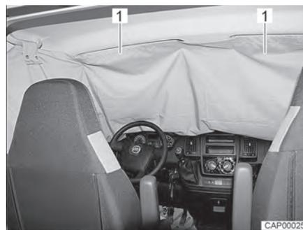
Fig. 18 Oscurante per cabina di guida sul parabrezza
