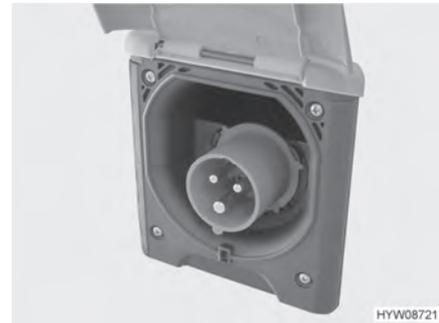
Fig. 57 Collegamento a 230 V al veicolo (presa CEE)
