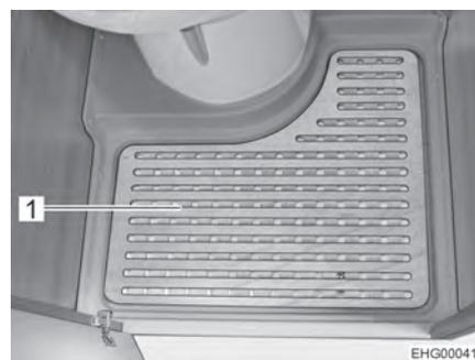
Fig. 86 Piastra del pavimento rimovibile
