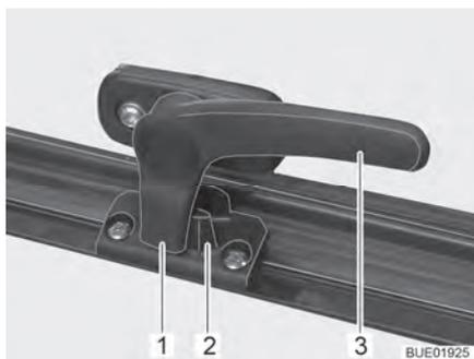
Fig. 12 Leva di serraggio in posizione "Chiuso"
