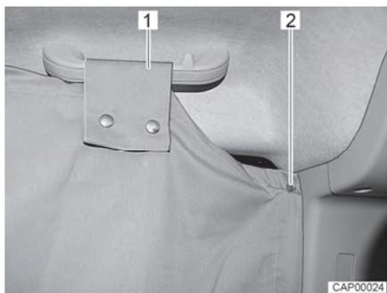
Fig. 17 Oscurante per cabina di guida sul finestrino laterale
