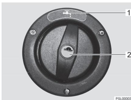
Fig. 76 Coperchio per bocchettone di riempimento dell'acqua potabile
