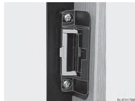
Fig. 74 Dispositivo di chiusura in posizione di ricircolo d'aria
