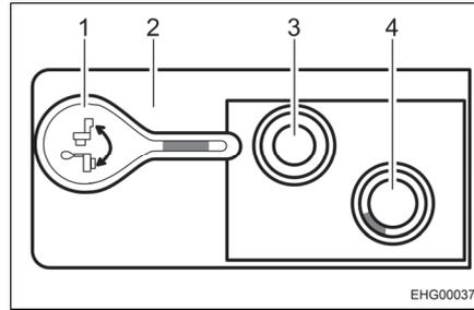
Fig. 68 Rubinetto di scarico, chiuso
