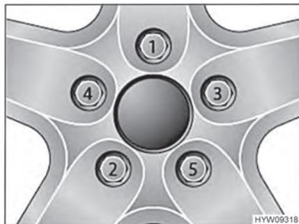
Fig. 94 Serraggio a croce di dadi delle ruote e bulloni delle ruote
