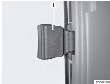
Bild 36 Skjutfönster utan lås
