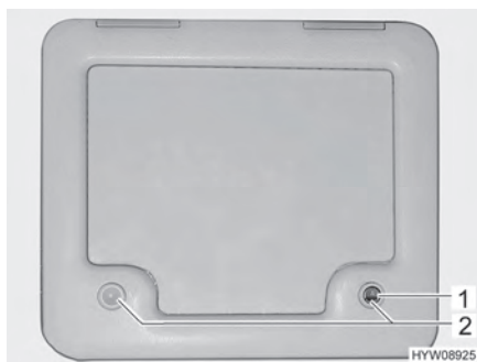
Bild 144 Lucka för latrintanken
